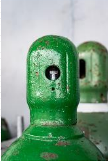
Đậy nắp để bảo vệ van chai khỏi hư hỏng Cylinder Valve Guard to protect valve from damages
