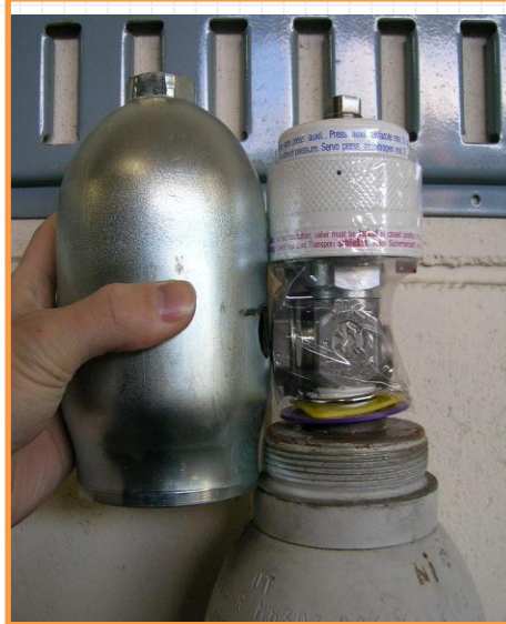
Đai ốc hoặc nút bịt kín khí đầu ra Gas tight outlet nut or plug
