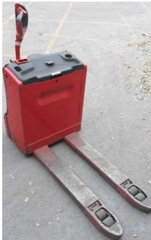
Hình | Figure 2: Ví dụ về xe nâng tay (có hỗ trợ) | Example of a manual (assisted) forklift
