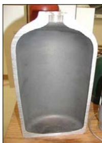
Mặt cắt một chai khí thông thường Cross section of a normal cylinder
