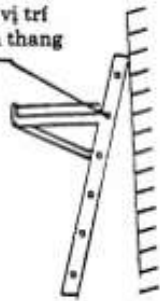
Công son lắp ở phía ngoài thang
