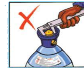
Không mở van bằng dụng cụ Must NOT open the valve by tool
