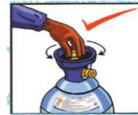
Phải mở van bằng tay Must open the valve by hand
