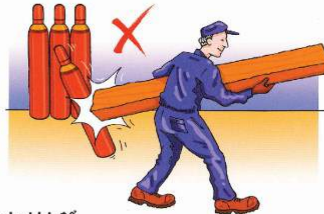
Luôn cố định chai khí để chống chai bị đổ Always secure cylinders to prevent them from falling.
