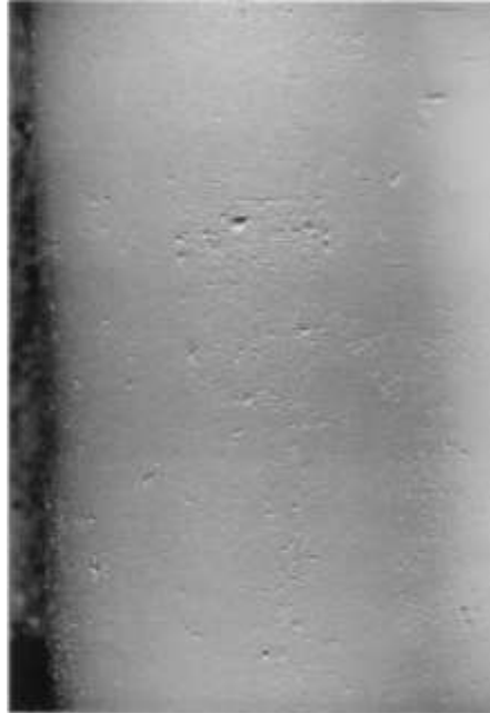
Hình 8– Ăn mòn chung với rỉ bị cô lập trên thành chai
