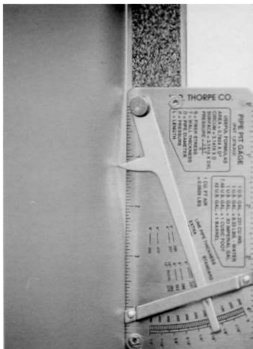
Hình 10— Đo chiều dài và độ sâu của vết lõm điển hình
