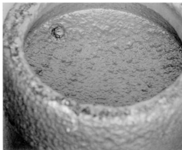
Hình 9– Ăn mòn chung với rỉ ở chỏm dưới
